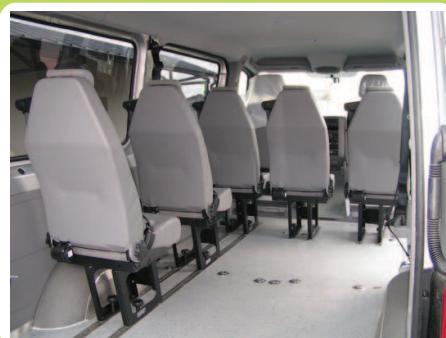
Plancher contreplaqué et sièges amovibles JANY
