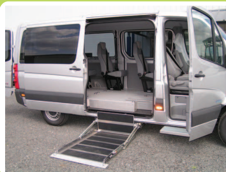
Accès latéral par cassette sous plancher
