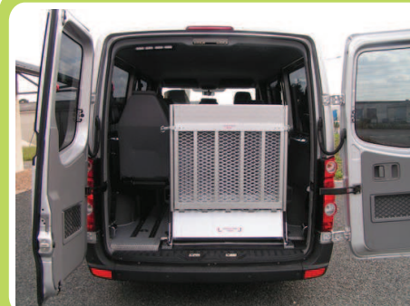
Accès arrière par rampe 3 volets : version maxi économique
